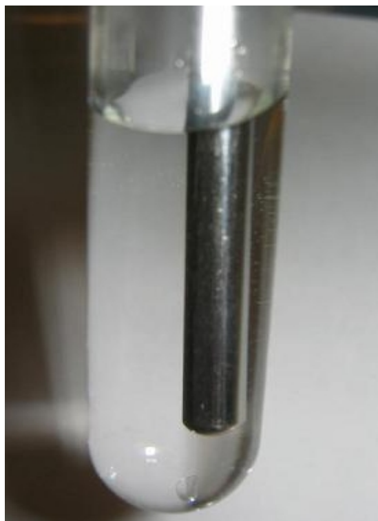
Kuva 17. Suolan kiteytyminen, koeputkessa näkyy lämpötila-anturi
