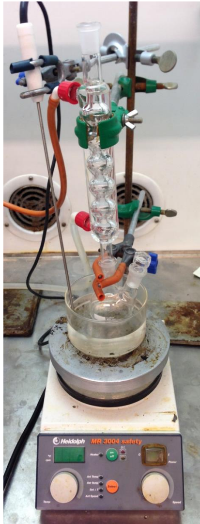
Kuva 10. Synteesilaitteisto, johon kuuluu jäähdyttävä vesikierrolla.
