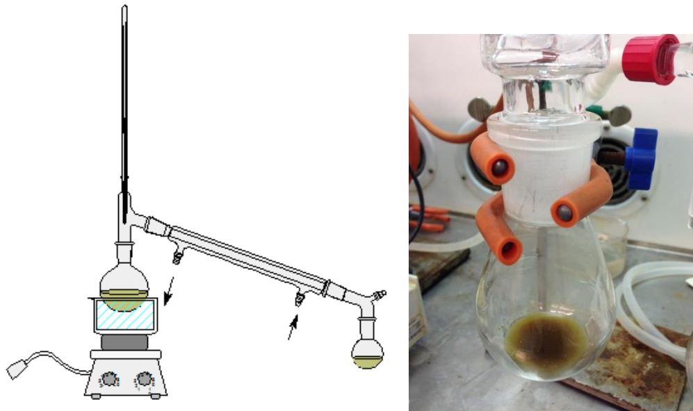
Vasemmalla on tislauslaitteiston kaavakuva (ilman statiiveja ja kouria), oikealla pihkauutos ennen liuotinten haihduttamista.
